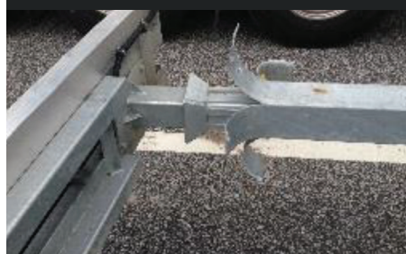
Skadebild efter kollision vid cirka 35 km/h
