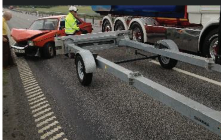
Skadebild efter kollision vid cirka 60 km/h
