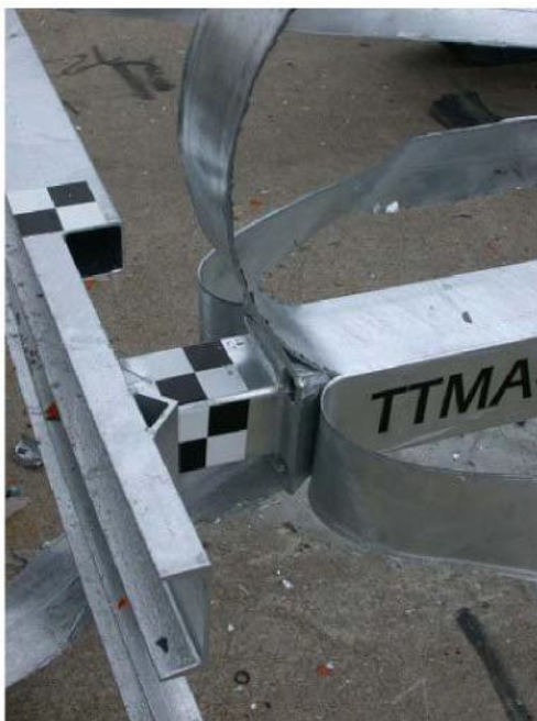
Figur 12a. Sprängning av energiabsorberande rör
