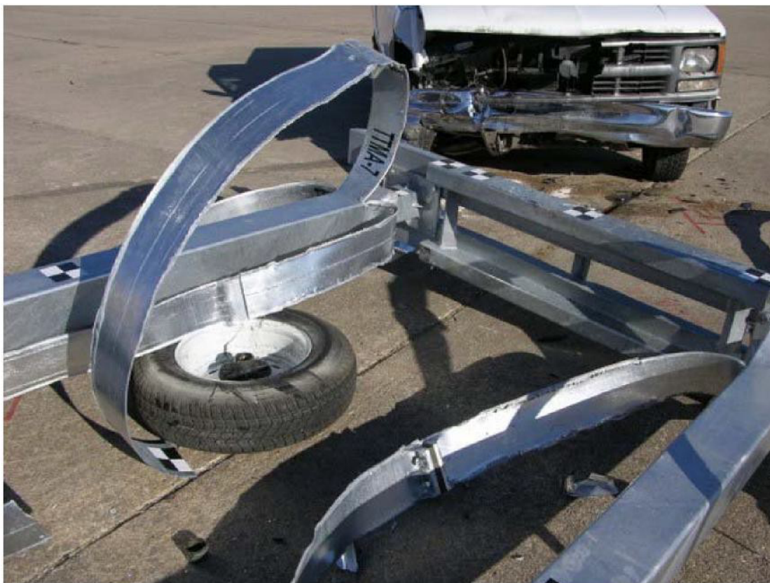
Figur 12b. Skador till följd av påkörning i medelhög hastighet
