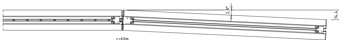
Bild 3 | Installation i kurvor med standardelement.
